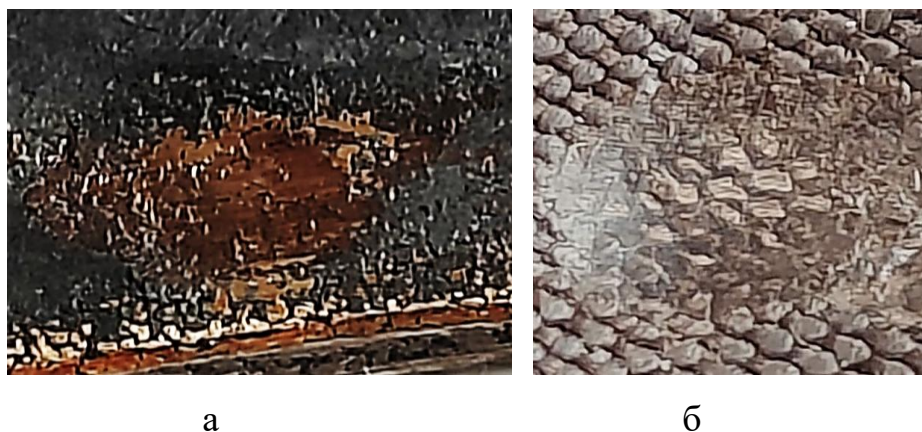
Рис. 3.6. Топографії пошкоджень поверхонь тертя металополімерної стрічки (а) та полімерного композиційного матеріалу Fluroglide (б) після випробувань на зносостійкість. Умови випробувань ( V = 0,033 м/с, \nu = 3 Гц, P = 30 Н, N = 10^5 циклів).
