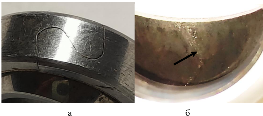
Рис. 5.7. Зони стику зовнішньої обійми шарнірного підшипника (а) та металополімерної стрічки (б)
