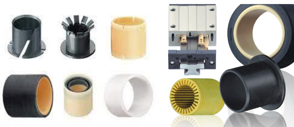
Рис. 1.20. Приклади полімерних підшипників ковзання виготовлених пресуванням, литтям під тиском та екструзією.
