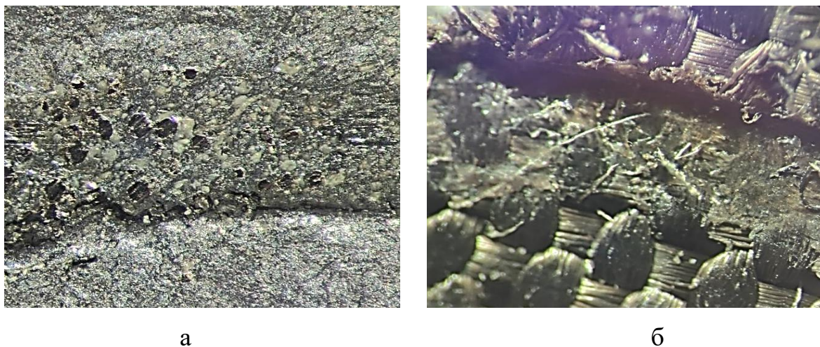
Рис. 3.3. Топографії поверхонь тертя матеріалів: металополімерної стрічки (а), Fluroglide (б), після випробувань в умовах вібраційних навантажень. Умови випробувань ( A=500 мкм, \nu=3 Гц, P=10 МПа, N=10^5 циклів, T=293 К).
