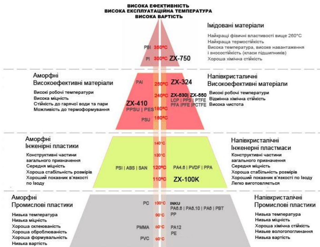
Рис. 1.17. Базові властивості та характеристика антифрикційних полімерних композиційних матеріалів Zedex.
