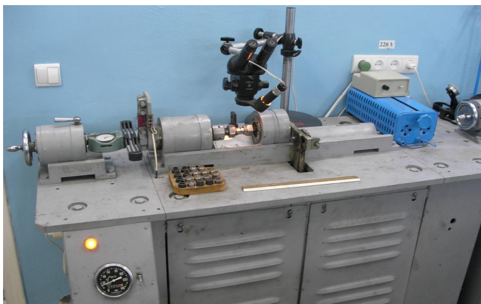
Рис. 2.2. Зовнішній вигляд машини МФК-1 для випробувань на фретинг-корозію.
